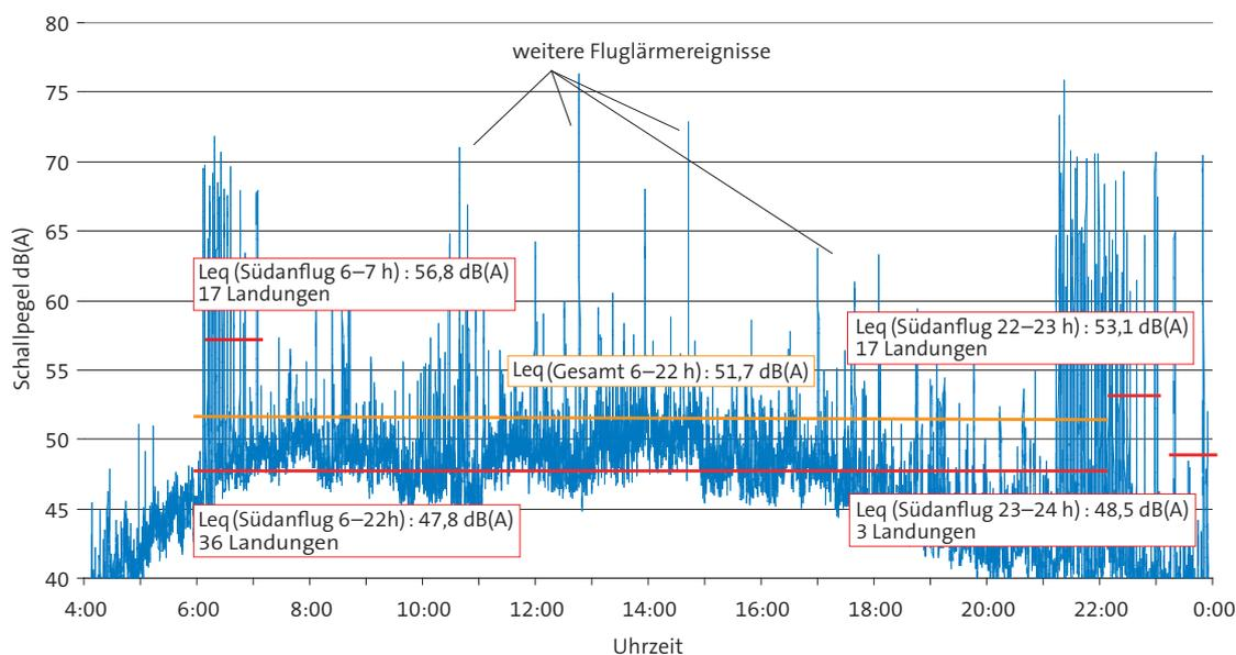
Der Schallpegelverlauf zeigt sämtliche Schallereignisse mit einem Pegel von mehr als 40 dB(A).
