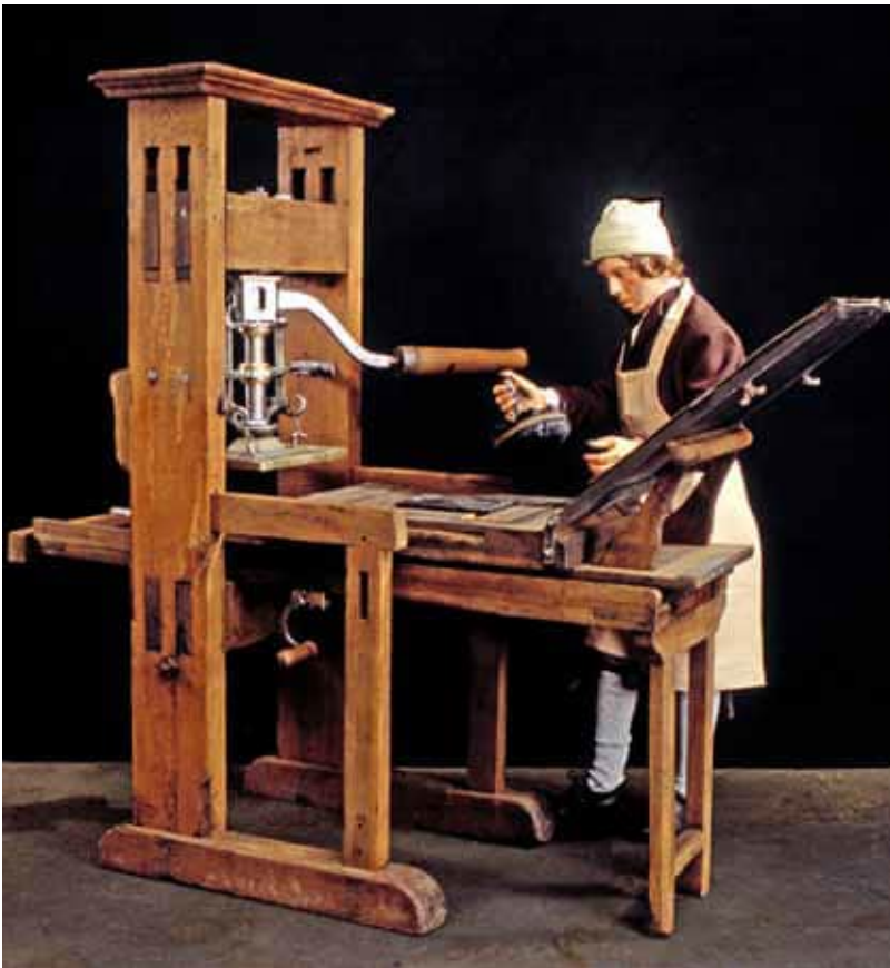
Abb. 3: Nachbau der von Gutenberg verwendeten einfachen Druckpresse. (Bild: Gutenbergmuseum, Freiburg, Schweiz)
